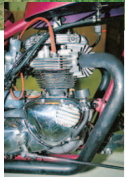
Förutom H-D-motorn finns det knappast någon mer välkänd motordesign än den på gamla Triumph Bonneville.
